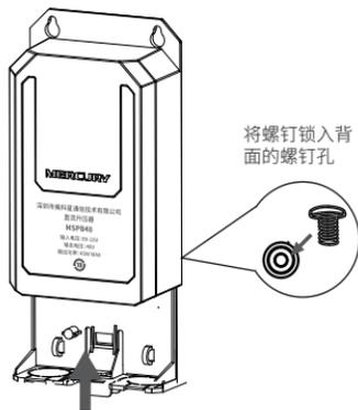
⑤ 一根扎带穿过顶部两个孔，一根扎带环绕机身，将设备固定在杆上。
